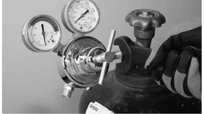
Fig3. Atasarea regulatorului de gaz
