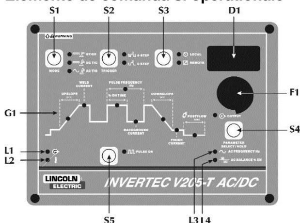
**L1 - Indicatorul luminos de alimentare:** este un indicator de culoare verde care arata ca masina a fost pusa in functiune prin actionarea comutatorului principal.
