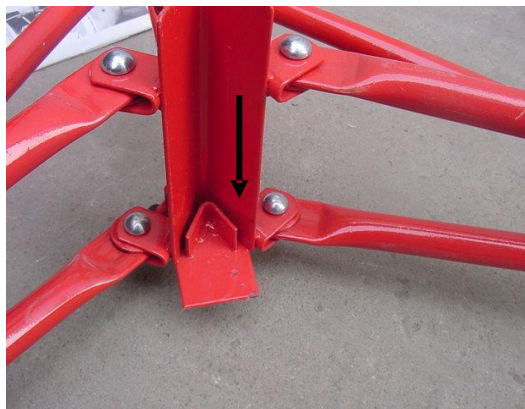
Fig 2. Pentru a menține baza trepiedului în poziție în timpul acestei proceduri, setați opritorul din spate, așa cum este arătat.
