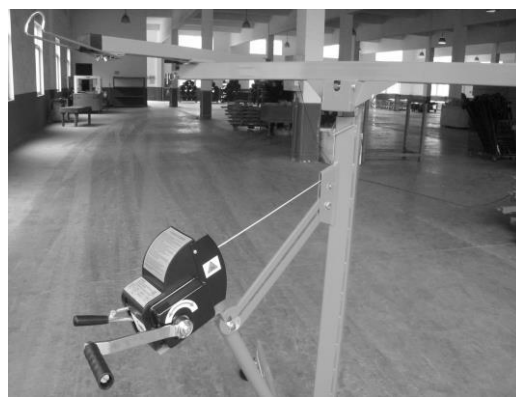
Fig 8. Se montează leagănul în partea superioară a secțiunii telescopice. Întoarceți zăvorul pentru înclinare pentru a permite înclinării leagănului pentru încărcare și pentru agățarea g de perete pe pereții laterali și tavanele înclinate.
