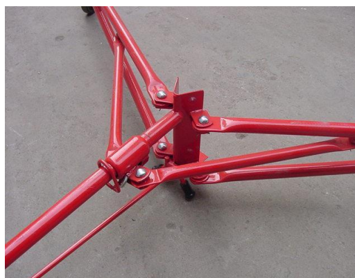
Fig 2. Pentru a menține baza trepiedului în poziție în timpul acestei proceduri, setați opritorul din spate, așa cum este arătat.
