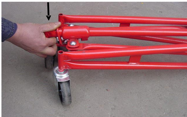
Fig 1. Începeți să setați baza trepiedului: apăsați în jos pe inelul cu glisare și rotiți picioarele exterioare până când se blochează în poziția de lucru (observați găurile din partea inferioară a tubului glisant).
