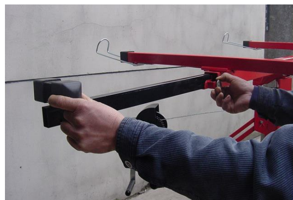
Fig 10. Pentru a extinde stabilizatorii pentru utilizare, scoateți pinul de blocare al stabilizatorului cu mâna dreaptă și a brațului transversal se va bloca. Glisați stabilizatorul cu mâna stângă ca și în figura. Pinul de blocare se va angaja în diferite puncte de pe stabilizator. ASIGURAȚI-VĂ că pinii de blocare sunt angajați într-una din aceste poziții înainte de a încărca unitatea. Retrageți stabilizatoarele când depozitați sau transportați unitatea.
