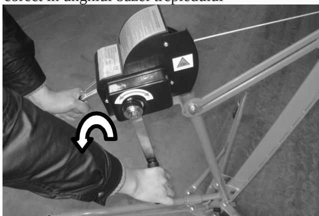
Fig 4. Asigurați-vă că unghiul ansamblului cadrului este corect în unghiul bazei trepiedului
