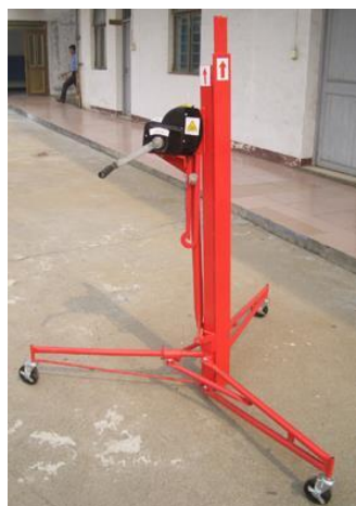
Fig 3. Așezați ansamblul cadrului pe baza trepiedului.
