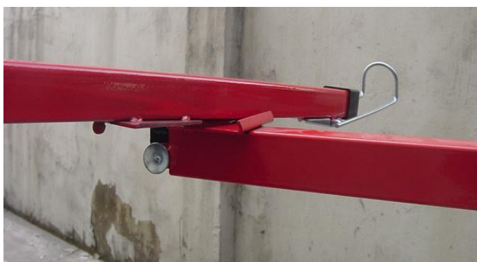
Fig 9. Poziționează placile conice ale bratelor transversale în prizele conice ale leaganului. Arcul va fi blocat în spatele bratelor transversale.
