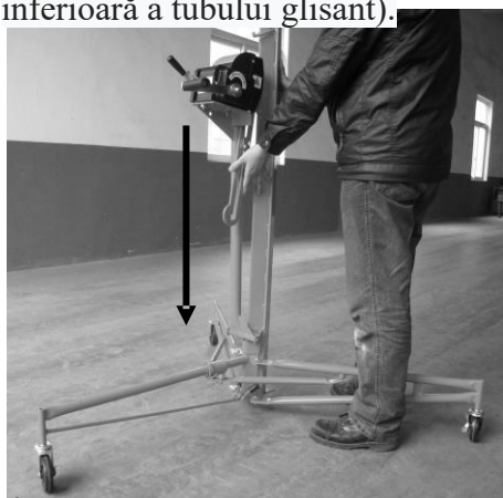
Fig 1. Începeți să setați baza trepiedului: apăsați în jos pe inelul cu glisare și rotiți picioarele exterioare până când se blochează în poziția de lucru (observați găurile din partea inferioară a tubului glisant).
