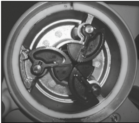
Fig. 4: Vorderes Spannfutter (19) Fig. 4: Front chuck (19) Fig. 4: Mandrin avant (19) Fig. 4: Mandrino anteriore (19) Fig. 4: Mandril de sujeción anterior (19) Fig. 4: Voorste spanklauw (19) Fig. 4: Främre spännchuck (19) Fig. 4: Fremre spennchuck (19) Fig. 4: Forreste patron (19) Kuva 4: Etuistukka (19) Fig. 4: Mordentes de aperto anteriores (19) Rys. 4: Przedni uchwyt zaciskowy (19) Obr. 4: Přední sklíčadlo (19) Obr. 4: Predné sklúčovadlo (19) 4. ábra: Első tokmány (19) Sl. 4: Prednji stezni uložak (19) Sl. 4: Prednji stezni uložak (19) Slika 4: Sprednja vpenjalna glava (19) Fig. 4: Mandrina anterioră (19) Fig. 4: Передний зажимный патрон (19) Εικ. 4: Μπροστινός σφιγκτήρας (19) Resim 4: Ön sıkıştırma mandreni (19) Фиг. 4: Преден универсал (19) 4 pav.: Priekinis kumštelinis griebtuvas (19) Att. 4: Priekšējā spīles ietvere (19) Joonis 4: Eesmine pingutuspadrun (19)
