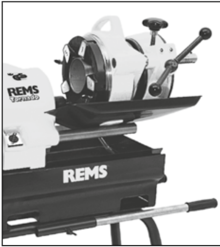
Fig. 6: REMS 4" Automatik-Schneidkopf auf REMS Tornado Fig. 6: REMS 4" automatic die head on REMS Tornado Fig. 6: REMS Tête de filetage automatique 4" montée sur REMS Tornado Fig. 6: Filiera automatica REMS 4" sulla REMS Tornado Fig. 6: REMS 4" cabezal de roscar automático sobre REMS Tornado Fig. 6: REMS 4" automatische snijkop op REMS Tornado Fig. 6: REMS 4" automatiskt skårhuvud på REMS Tornado Fig. 6: REMS 4" automatisk skjærehode på REMS Tornado Fig. 6: REMS 4" automatisk gevindskærehoved på REMS Tornado Kuva 6: Automaattinen REMS 4"-kierrepää REMS Tornadossa Fig. 6: Cabeça automática REMS 4" montada sobre a REMS Tornado Rys. 6: Automatyczna głowica gwinciarzka REMS 4" dla REMS Tornado Obr. 6: Automatičká závitorezná hlava REMS 4" na REMS Tornado Obr. 6: Automatičká závitorezná hlava REMS 4" na REMS Tornado 6. ábra: REMS 4" automatikus menetvágó fej a REMS Tornado-ra Sl. 6: REMS 4" Automatik narezna glava za REMS Tornado Sl. 6: REMS 4" avtomatska rezna glava na uredaju REMS Tornado Slika 6: REMS 4" avtomatska rezalna glava na REMS Tornado Fig. 6: REMS 4" cap de filatat automat pe REMS Tornado Fig. 6: Автоматическая резьбонарезная головка REMS 4" на REMS Торнадо Eik. 6: Αυτόματη κεφαλή κοπής REMS 4" στη μηχανή REMS Tornado Resim 6: REMS 4" otomatik pafta açma kafası, REMS Tornado üzerinde Фиг. 6: REMS 4" автоматична винторезна глава върху REMS Торнадо 6 pav.: Automatinė sriegimo galvutė REMS 4" naudojama su REMS Tornado Att. 6: REMS 4" Automatiškā griežņa galva uz REMS Tornado Joonis 6: REMS 4" automaat-lõikepea REMS Tornadol
